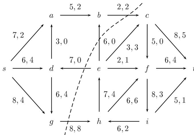
Figura 11: Rete della Figura 9 con flusso massimo e taglio minimo.
