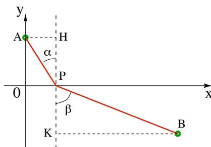
FIGURA 13. Gli angoli di incidenza e di rifrazione.
